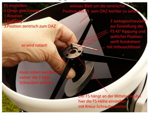
Ein weisses Blatt Papier, gegenüber dem OAZ angeklebt, hilft sehr um die Position des FS zentrisch zum OAZ zu machen. Sonst ist das vor lauter Schwärze im Tubus kaum zu sehen. Man muss in den OAZ schauen und sehr Acht geben, mit dem Auge möglichst auf der Achse des OAZ-Rohrs zu sein. Das OAZ-Rohr muss ganz symmetrisch rund aussehen. Hier tut man sich mit einem Cheshire Okular viel leichter. Mit einigem Gefühl bekommt mans hin:
