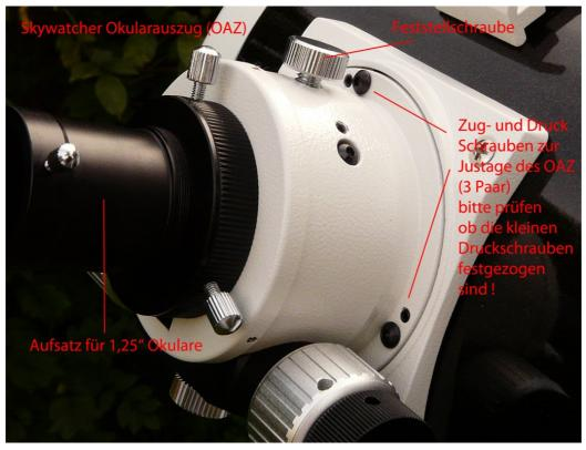
Also zuerst prüfen ob die Druckschrauben festgezogen sind! Später mal kann man die zur genauen Ausrichtung des OAZ zum Tubus benutzen. Jetzt kommt die Hauptaufgabe, die Einstellung des FS. Auf drei Dinge gleichzeitig muss man achten:
