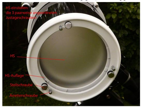
Hier noch genauer ein Schraubenpaar: Die Stellschraube verschiebt den HS, eine Feder sorgt für Verspreizung. die Konterschraube fixiert ihn wieder.
